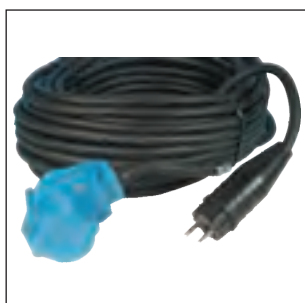
40011 Kabel 25m Hann schuko + vinkelstikk. 3x2,5mm 2 .
