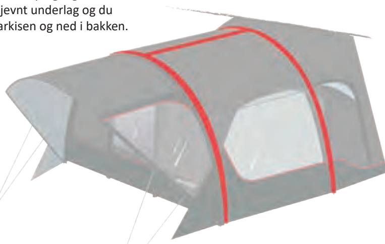
De røde strekene på tegningene viser hvor luftslangene er.
