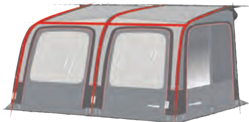
De røde strekene på tegningen viser hvor luftslangene er.
