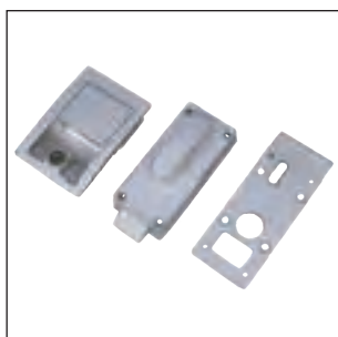
55026 Dørlås MC kort Leveres komplett med både utvendig og innvendig del, samt to nøkler. Minimum veggtykkelse 24mm. Mål LxB: 115x66mm.
