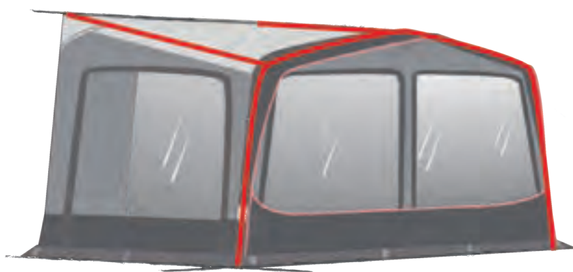
De røde strekene på tegningen viser hvor luftslangene er.
